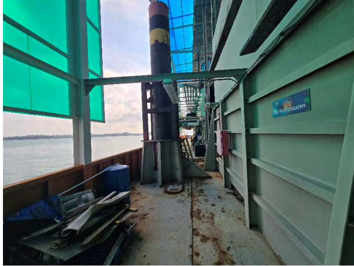
Starboard spud anchor.
